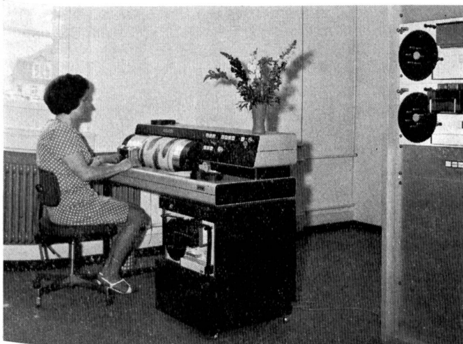
Eine Spezialistin bedient die elektronisch gesteuerte Musterungsmaschine MVS 200
