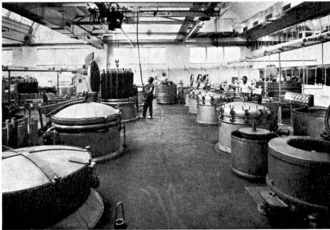
«Helanca» ® -Garnfärberei mit automatisch gesteuerten Färbeapparaten
