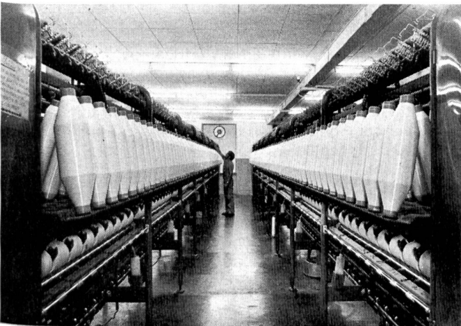
Texturiermaschinen für Nylongarne (Kräuselgarne)
