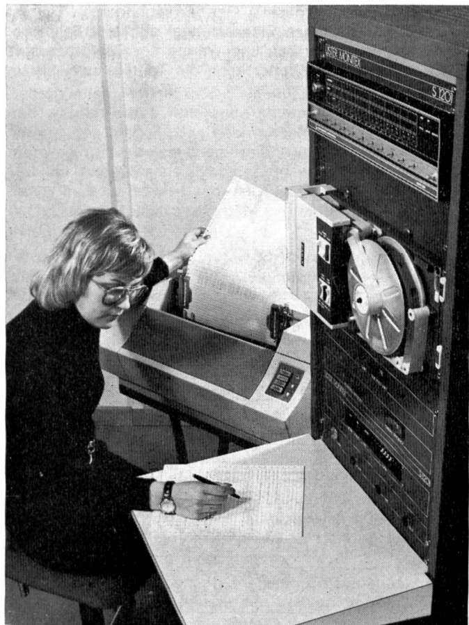
Zentraleinheit (mit Computer und Schreibeinheit) der computergesteuerten Datenerfassungsanlage Uster Monitex S 1200
