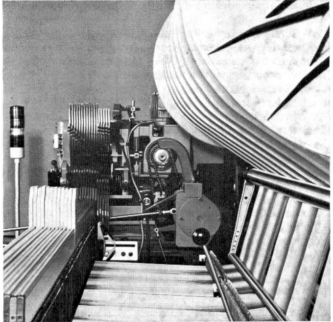
Diese Seitenansicht zeigt den einfachen Lauf der Polkette sowie das zentrale Frottieraggregat
