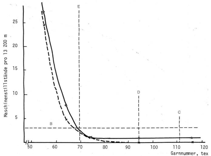
Abbildung 7 Spinnverhalten von 30,2  $\mu$ -Vorgarnen bei optimierten Streckwerkeinstellungen
