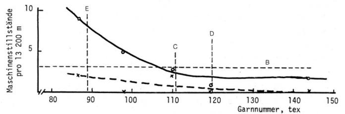
Abbildung 11 Spinnverhalten von 34,2  $\mu$ -Vorgarnen
