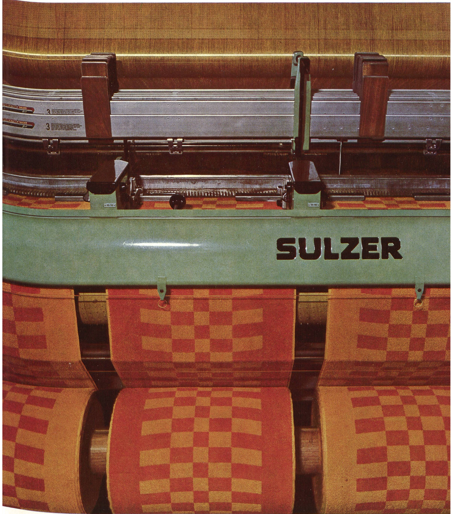
Mehrbahniges Weben auf der SULZER-Frottierwebmaschine
