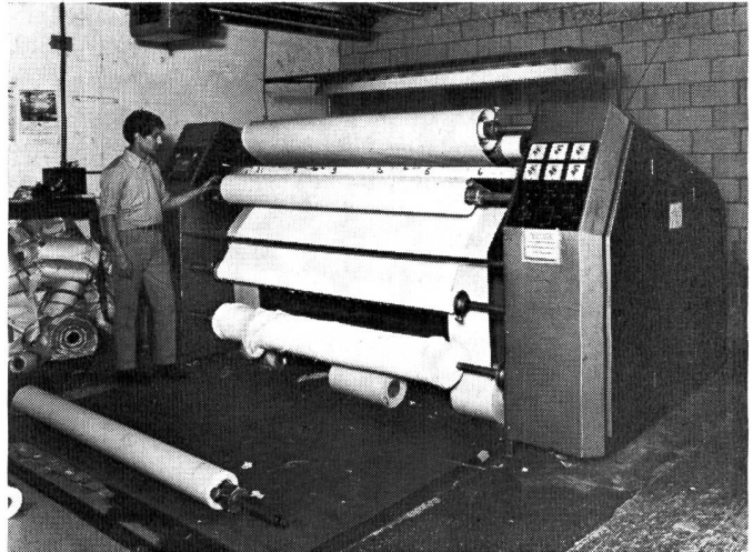
Diese Maschine des Typs BTP 72 bedruckt synthetische Gewebe sowie synthetische Mischgewebe mit maximal 25 % Naturfaser bei Breiten bis zu 1,82 m. Die sehr klaren Muster sind wasch- und lichtecht (The Bates Textile Machine Company, Leicester, Ltd., Old Mill).
