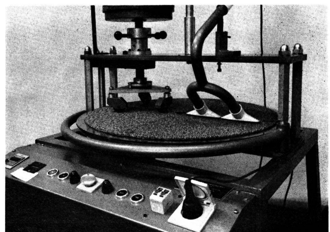
Rollstuhltest. Nach 5000 und 25 000 Umdrehungen des Probentisches wird der Teppich beurteilt. Die Rollen drücken mit je 30 kp auf den Teppich.
