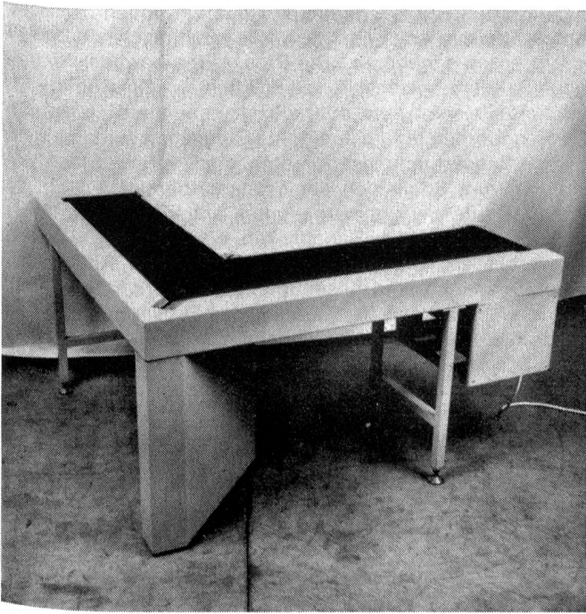
Abbildung 4 Transportband auf Winkeltisch. Das Transportgut ändert seine Bewegungsrichtung um 90°. Im Winkel läuft das Band über polierte Kanten mit kleinen Krümmungsradien. Winkelbänder können normal zugeschnitten werden. Die Umlenkung unter den Kanten geschieht durch schräggestellte normale Umlenkrollen (Bild Habasit AG).
