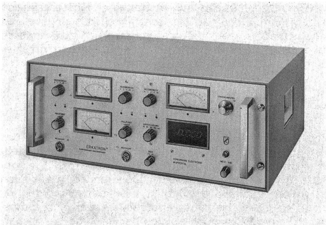
Abbildung 2 Erkatron – Elektronischer Analogrechner für Reibungskoeffizientenrechnung. Geräteausführung mit Digitalanzeige.
