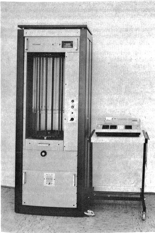
Abbildung 4 Kräuselkontraktions-Messgerät «Texturmat» mit Rechner
