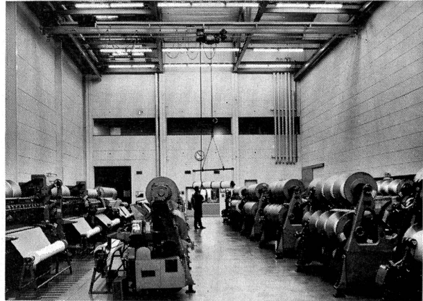
Abbildung 4 Einträger-Hängekran zum Kalanderttransport
