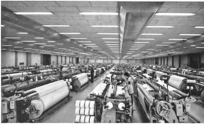
Abbildung 7 Blick in den konventionell klimatisierten Websaal T4 mit 204 Sulzer-Einfarbenwebmaschinen mit Exzentermaschine in Nennbreiten von 85'' (216 cm), 130'' (330 cm) und 153'' (389 cm). An der Websaaldecke: die perforierten Zuluftkanäle.
