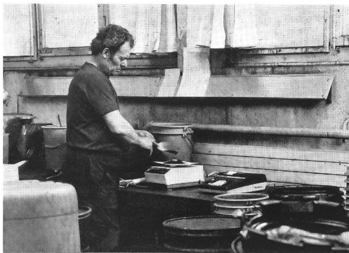
Abbildung 2 Jede Einwaage in der Farbküche wird protokolliert
