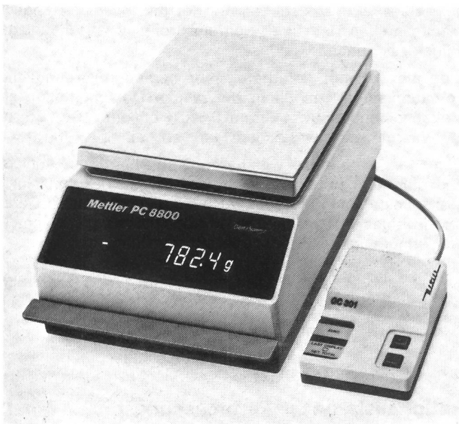
Abbildung 4 Wägen bis 8 kg mit feiner 0,1-g-Anzeige
