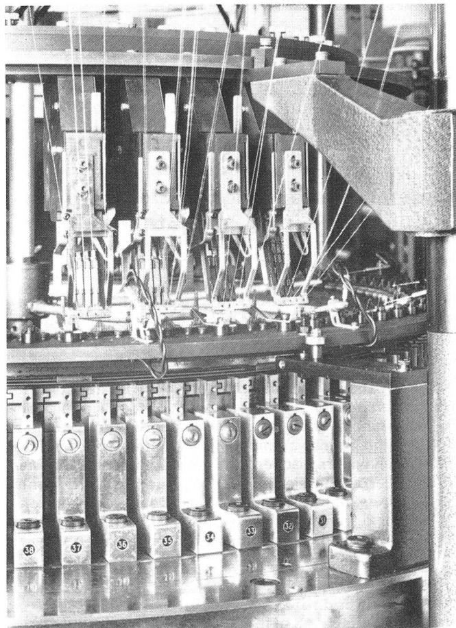
Programmierbare elektronische Ringelapparate, angebracht an jedem zweiten Stricksystem einer Camber-Single-Jersey-Rundstrickmaschine
