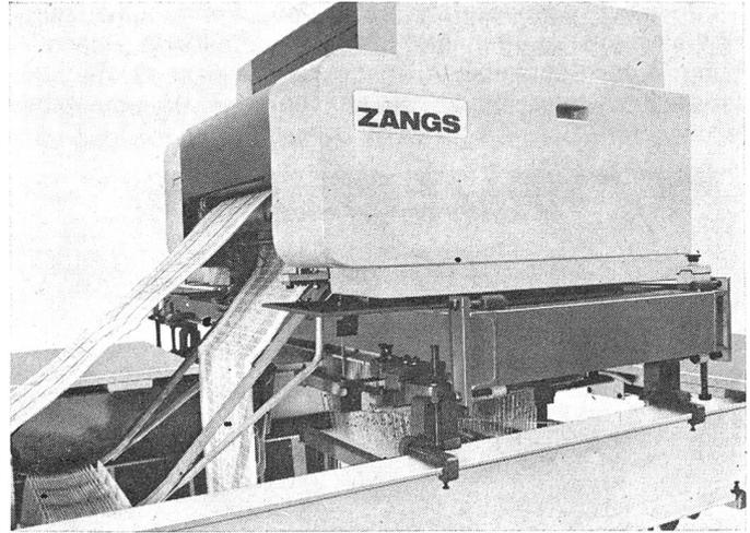
Zangs-Jacquardmaschine 356 Doppelhub-Ganzoffenfach mit Schrägfach, 1344 Platinen.
