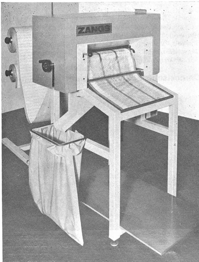
Kartenschnellstanze Patropunch® 528 innerhalb des Zangs-Patrocard-Systems® 525, einem rechnergesteuerten Verarbeitungssystem der Jacquard-Ateliertechnik, mit Abrolleinrichtung 527 für gerolltes Kartenpapier.
