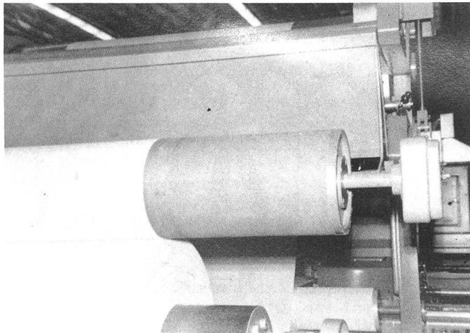
Bild 6 Wickler mit ausgeschwenkter Schutzhaube
