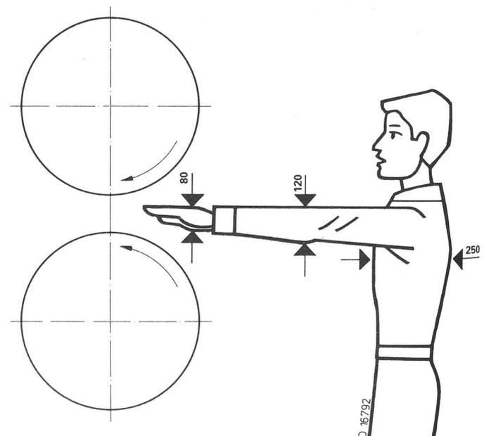
Bild 9 Erforderliche Walzenabstände bei Annäherung entsprechender Körperteile
