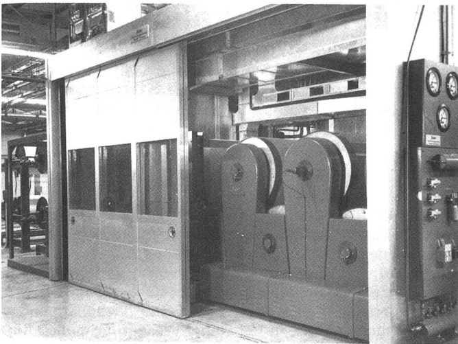
Abb. 9: Sucker-Wärmerückgewinnungsanlage, System Wiessner
