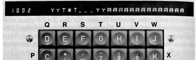
Abb. 12 Jacquardeingabe so wie sie der Stricker in der Anzeige sieht. Musteränderungen werden direkt an den darunter liegenden Tasten durchgeführt.
