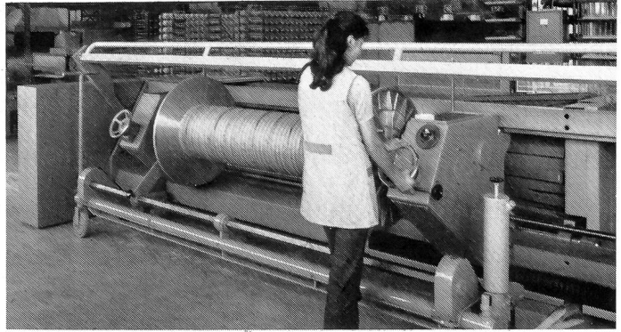
Abb. 2 SC-PERFECTRONIC Bäumseite mit Kettbau-Hubwagen
