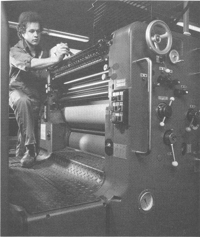
Die Offsetplatte ist auf dem hellen Zylinder aufgespannt und wird vom Farbwerk (oben) eingefärbt und druckt sein Bild auf den dunklen Zylinder, der dasselbe Druckbild auf das Papier abgibt.
