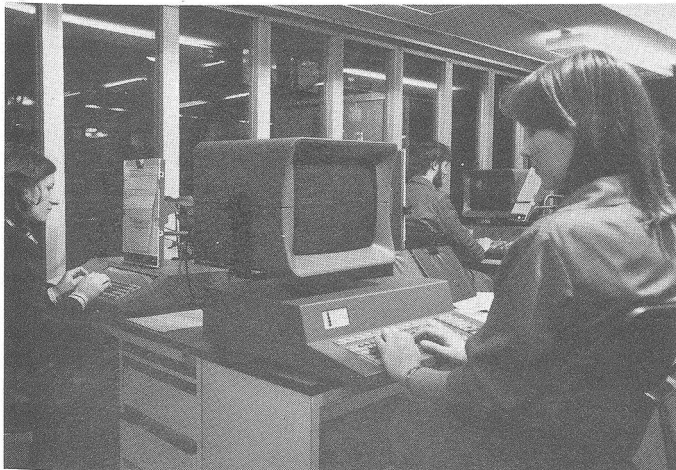
Die Tasteinheiten des Lichtsatzsystems. Hier wird der Text für die «mittex» gesetzt.
