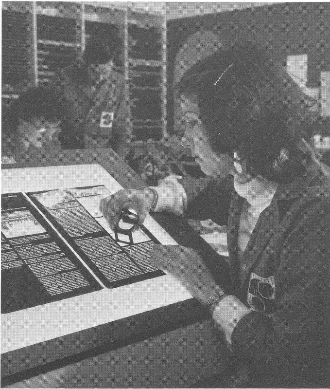
In der Lichtsatzmontage wird der Text umbrochen und einzelne Satzelemente zu ganzen Filmsatzseiten zusammengestellt.
