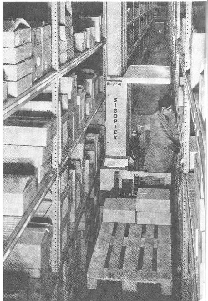
SIGOPICK-Kommissioniergerät im Einsatz im Textillager eines Grossverteilers. Die Bedienungsperson kommissioniert aus den Tablarregalen direkt auf die Palette. Letztere wird durch höhenverstellbare Gabeln getragen. Die günstige Arbeitshöhe kann gewählt werden.
