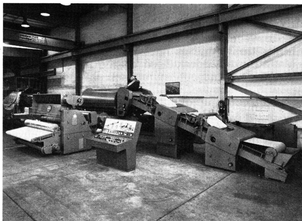
Bild 1 Nonwoven-Anlage, Type V 21/K 12: 2,6 m Arbeitsbreite
