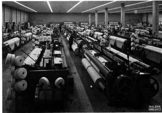
Abb. 3 Sulzer-Webmaschinenanlage der Wisselink's Textiefabrieken BV in Aalten, Niederlande, mit 76 Projektilewebmaschinen. Zur Reinigung seiner Maschinen und Produktionsräume setzt das Unternehmen eine zentrale Sulzer-Vakuum-Reinigungsanlage mit einem Fördervolumen von 2100 m 3 /h ein.
