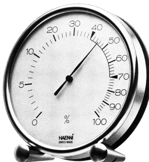
Figur 5 Raumhygrometer als Standmodell für Büro- und Wohnräume. Als Fühler wird speziell behandeltes Naturhaar verwendet.
