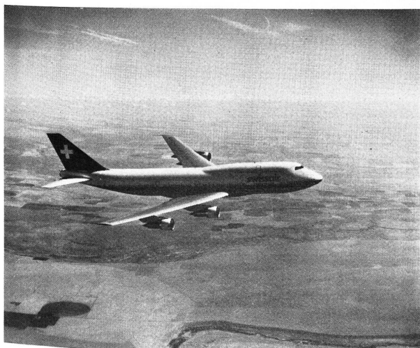
Der Combi transportiert ca. 30–40 Tonnen Luftfracht auch bei voller Passagierauslastung. Neue Dimensionen für Swissair Luftfracht.
