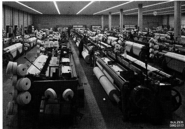
Abb. 3 Sulzer-Webmaschinenanlage der Wisselink's Textiefabrieken BV in Aalten, Niederlande, mit 76 Projektwebmaschinen. Zur Reinigung seiner Maschinen und Produktionsräume setzt das Unternehmen eine zentrale Sulzer-Vakuum-Reinigungsanlage mit einem Fördervolumen von 2100 m 3 /h ein.
