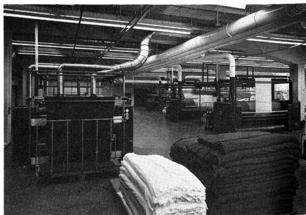
Teilansicht in der Ausrüsterei, rechte Bildhälfte Rauhmaschinen, links Schermaschinen
