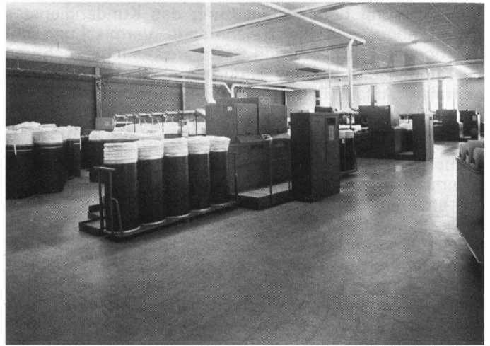
Im Vordergrund die doppelköpfige Strecke D1/2. Die neuesten technologischen Erkenntnisse wurden hier verwirklicht. Der Rolleneinlauf-tisch gewährleistet auch bei sehr hohen Geschwindigkeiten einen sicheren Bandabzug. Fehlende Bandstücke gibt es mit dem D1-Konzept nicht mehr.
