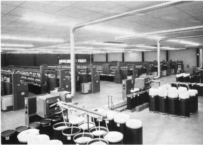
Gesamtansicht der mit 10 Rieter OE-Rotorspinnmaschinen M2/1 (links) und 6 Strecken D1 bestückten OE-Produktion in dem grosszügigen und arbeitsattraktiven Gebäude.
