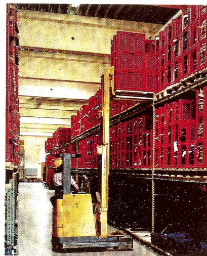
Abb. 5 Schäfer-Hochregalanlage für das Reservelager zur Aufnahme von Euro-Paletten, bestückt mit je 12 Euro-Fix-Kästen
