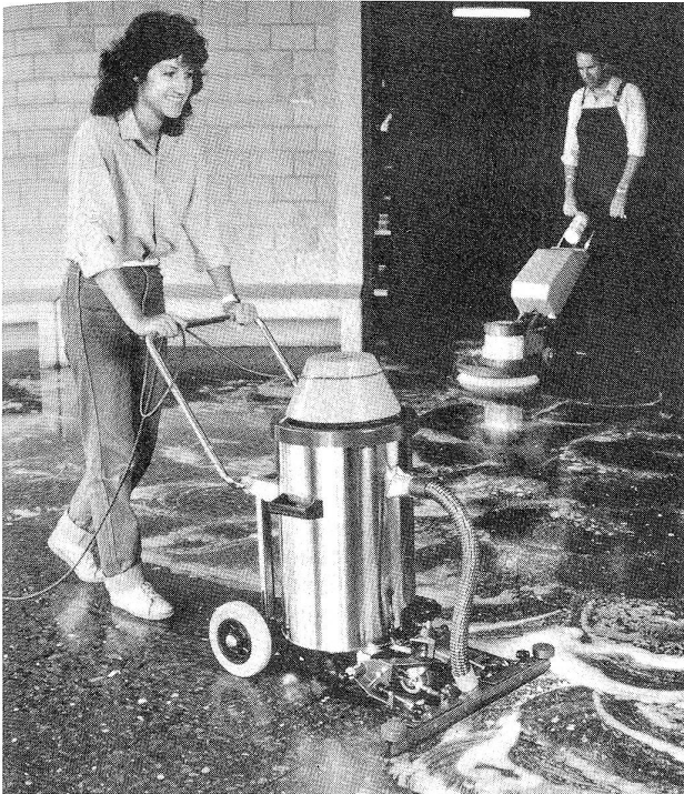
Bild 2 Grundreinigung mit Einscheibenmaschine und Wassersauger: das rasche Absaugen verhindert bei Böden mit Holzanteil das Eindringen des Schmutzwassers.
