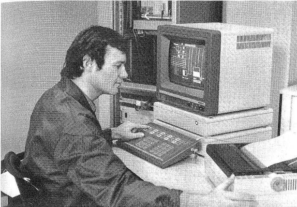
Prozessvisualisierungssysteme – wie das System Coros S5 von Siemens-Albis – erleichtern das schnelle und sichere Erkennen sowie Lokalisieren allfälliger Störungen und tragen dadurch viel zur hohen Verfügbarkeit von mit speicherprogrammierbaren Steuerungen ausgerüsteten Anlagen bei.
