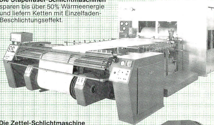
● Die Zettel-Schlichtmaschine beschlichtet prozeßsicher mit 400 m/min Filamentgarne mit programmierten Daten.
