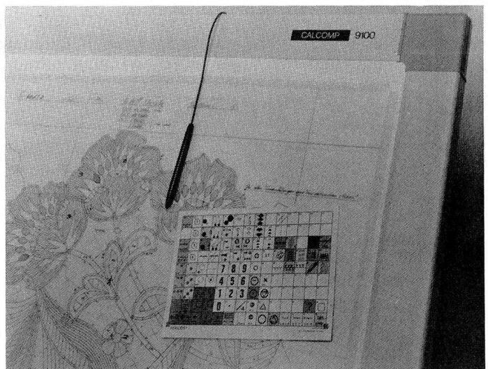
Das Digitalisiertableau mit Stickereizeichnung, Menüfeld und Taststift ersetzt die alte, mechanische Punchedmaschine. Mit diesen neuen Hilfsmitteln und dem Computer-Programm (Software) werden in Zukunft die Steuerprogramme für Stickmaschinen erstellt.
