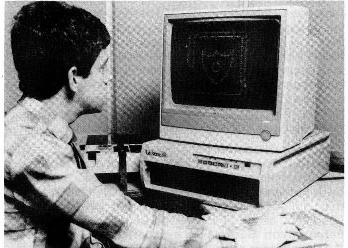
Das Easypunch-System gestattet das Entwerfen von Stickmustern auf einem Bildschirm, bevor diese automatisch auf die zur Steuerung der Stickmaschinen verwendeten Lochstreifen übertragen werden.
