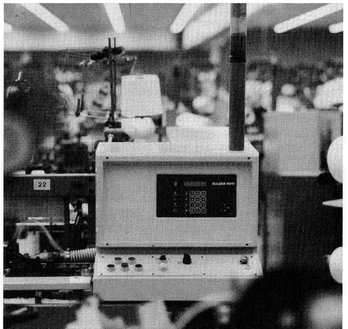
Herzstück der Webmaschinenüberwachung und -steuerung: der Mikroprozessor
