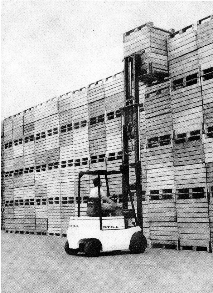
Still Kompaktstapler stapelt Leergut auf über 6 m Höhe. Foto: Still GmbH.
