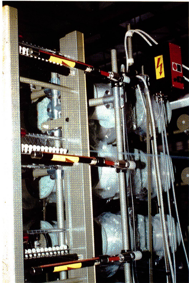
Ein Foto aus der Praxis: Gut zu erkennen sind die Aufnahmeeinrichtung, sowie das ausgereifte Kontaktsystem zwischen Spannungsversorgung und Ionisatoren, die einzeln auswechselbar sind.
