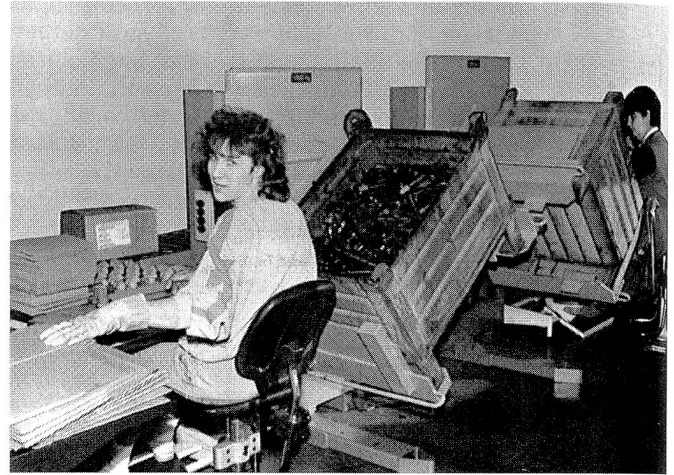
Palettenhub-Kippgeräte verhindern Rückenschmerzen durch Arbeiten auf der idealen Arbeitshöhe und reduzieren die Arbeitszeit.
