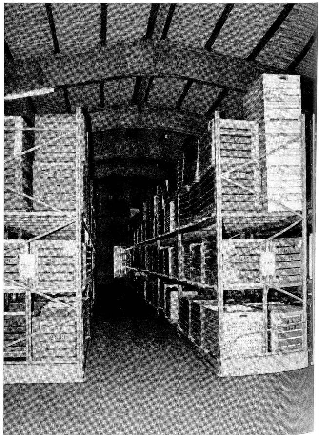
Blick ins Garnlager. Die einzelnen Regale werden auf Schienen bewegt. Das Ergebnis ist eine Platzeinsparung von 50% in der Lagerhalle. Foto «mittex»
