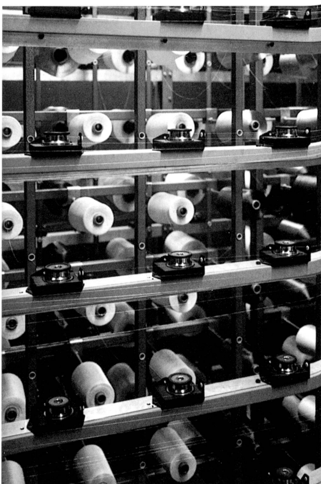
HACOBA-Schärgatter mit neuer Fadenbremse HH-FB
