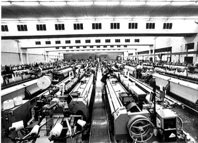
Bei der Spinnerei & Weberei Dietfurt AG sind rund 400 Webmaschinen «on-line» an eine EDV-Anlage angeschlossen, welche es ermöglicht, jede einzelne Maschine exakt zu disponieren und die Terminüberwachung fast auf die Minute genau sicherzustellen.
