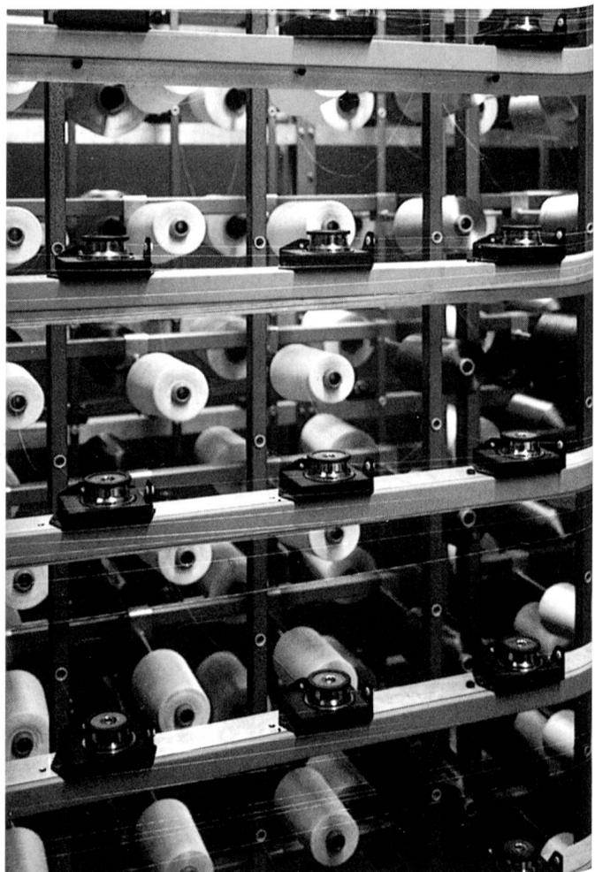
HACOBA-Schärgatter mit neuer Fadenbremse HH-FB
