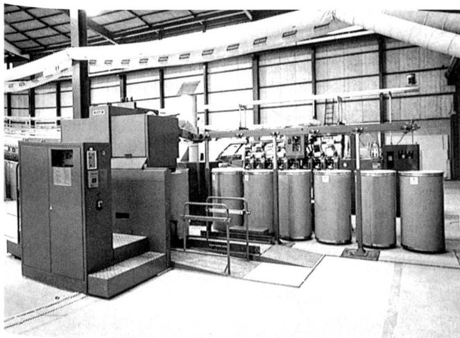
Die Strecke D1/A ist praxiserprobt und in den Funktionen Getriebe, Streckwerk und Einlauftisch weiterentwickelt.
