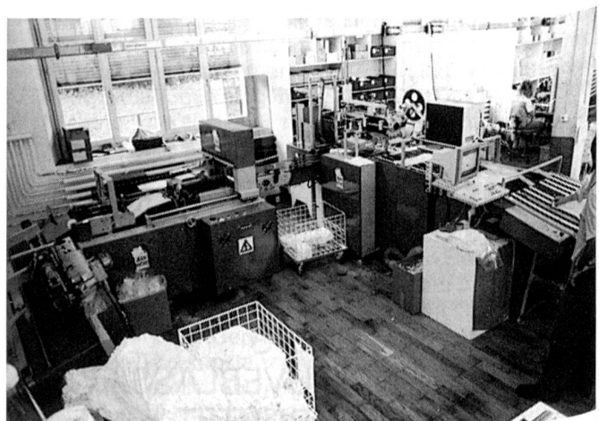
Neuer Verpackungsautomat und U-Stellung: rechts aussen am Bildrand das noch manuelle Auflegen der einzelnen Wäscheteile; anschliessend erfolgen das Legen und der Aufdruck der entsprechenden Etikette, in der Bildmitte die Verpackung und links aussen das Verschweissen.
