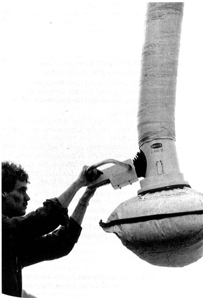
Das Heben und Transportieren gefüllter Säcke mit 20 oder 50 kg Inhalt war bisher das Sorgenkind der Handhabungstechnik. Sie sind kaum zu packen, ohne dass man sie verletzt, ihre Haut, vielfach aus Papier oder dünner Plastikfolie, hat Tendenz zum Reißen, und ihr Inhalt verformt sich gerade nach Lust und Laune.
