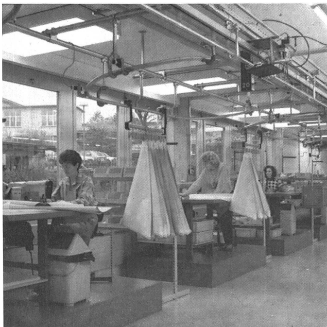
Zielgesteuerte Arbeitsplatz-Beschickung mit Hängebahn. Meiko Meier AG
