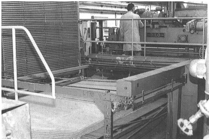
Bei Matratzeinlagen erfolgt, EDV-gesteuert, automatisch eine Mittelzonenverstärkung.
