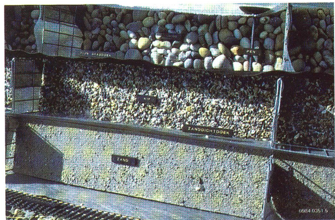
Bild 8 Schnitt durch die als Filter aufgebaute Fundierungsmatratze. Aufbau der Matratze:
