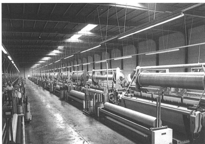
Webmaschinenanlage Lystex der Beaulieu-Management-Gruppe in Comines, Belgien, mit 126 Sulzer Rütli Projektilwebmaschinen des Typs P 7100, auf denen qualitativ hochwertige Polypropylen-Teppichgrundgewebe hergestellt werden.
