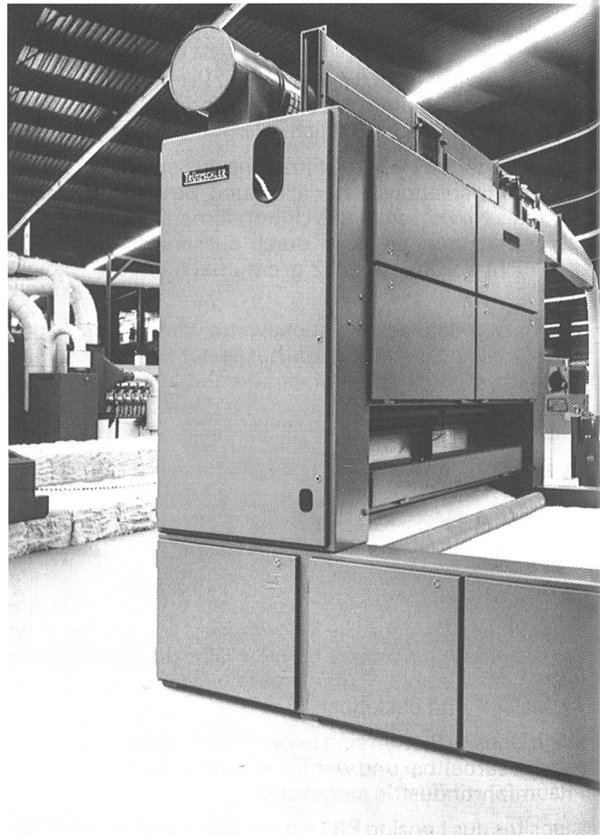
Exactafeed® FBK 536 Flockenspeiser für Krempeln
