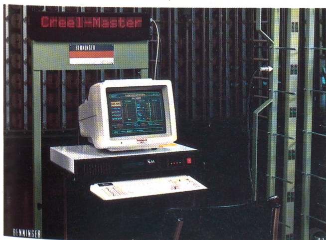
Commander-Einheit des Creel-Master-Systems mit einfacher menügeführter Bedienung
